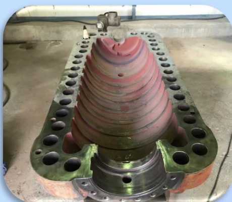
تعمیر پوسته فید پمپ توسط جوشکاری قوسی کم حرارت
