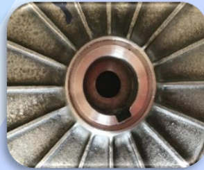
تعمیر پروانه تیتانیومی مربوط به صنایع نفت و گاز
