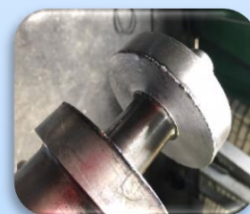
تعمیر روتور توربین بخار توسط جوشکاری کم حرارت
