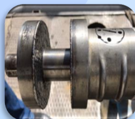
تعمیر روتور توربین بخار توسط جوشکاری کم حرارت
