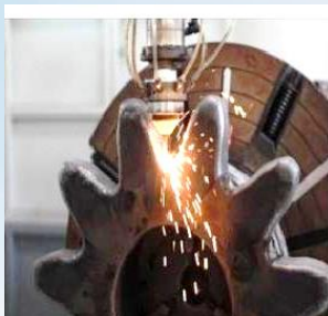
روکشکاری لیزری دندانه های چرخ دنده
